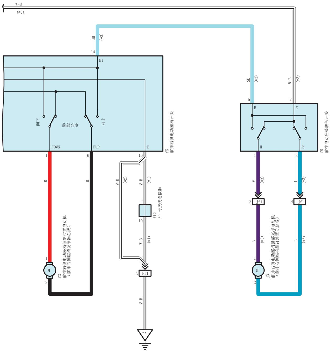
电动座椅 (驾驶员座椅不带座椅位置存储器) (右驾驶车型)
